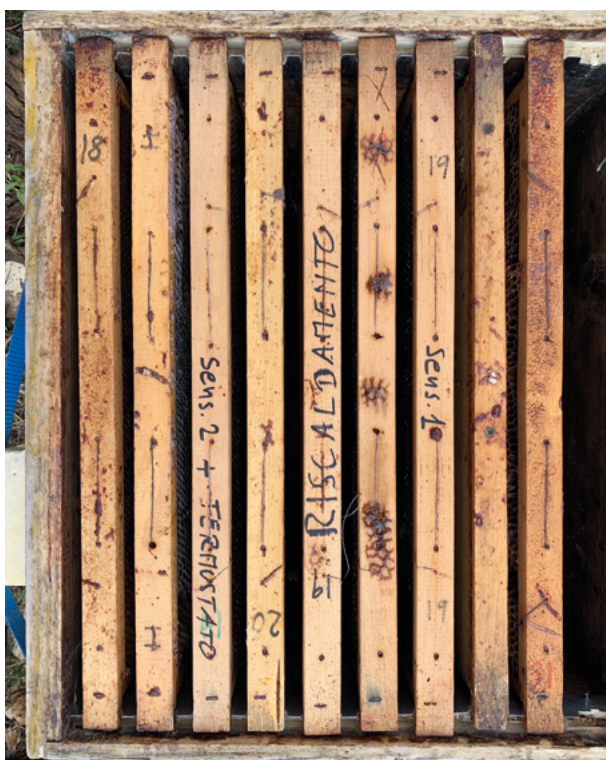
Figura 6 | Disposizione del riscaldamento e dei favi nell'arnia. L'ultimo spazio è vuoto per fare posto all'ingombrante potenziometro dell'elemento riscaldante
