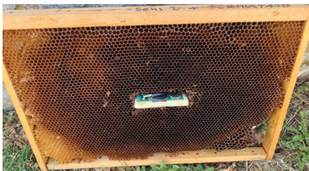
Figura 5 | Posizionamento del datalogger e del sensore del termostato all'interno di un favo da nido
